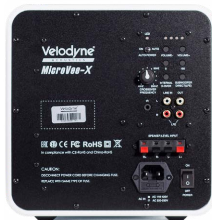
An der Rückseite kann der Pegel und die Phasenlage eingestellt sowie der Bypass für die interne Weiche und die automatische Abschaltung aktiviert beziehungsweise deaktiviert werden (Foto: Velodyne)
